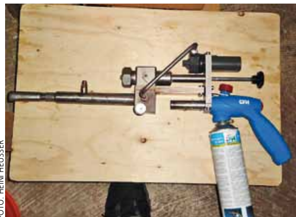
Oxalsäureverdampfer mit doppelwandigem, Wärmeöl gefülltem Verlängerungsrohr.
